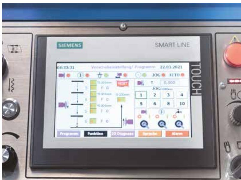
Si se ajusta en el modo Auto, los parámetros de desbaste y acabado definidos por el usuario, el número de chispas y el retorno a cero se procesan automáticamente
