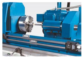
Шлифовальная бабка может поворачиваться на 180° при переходе с внутреннего шлифования на внешнее
