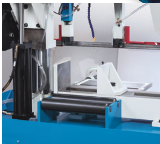
Роликовая опора для упрощения подачи материала
