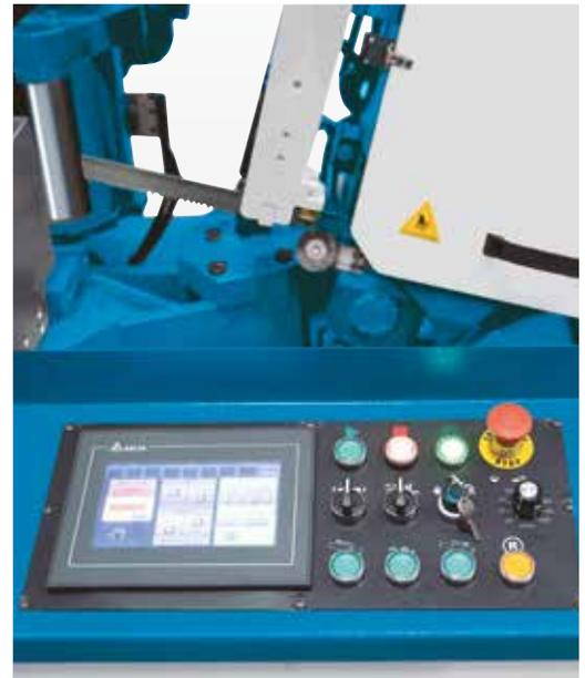
La pantalla táctil permite una programación fácil y cómoda para un funcionamiento totalmente automatizado
