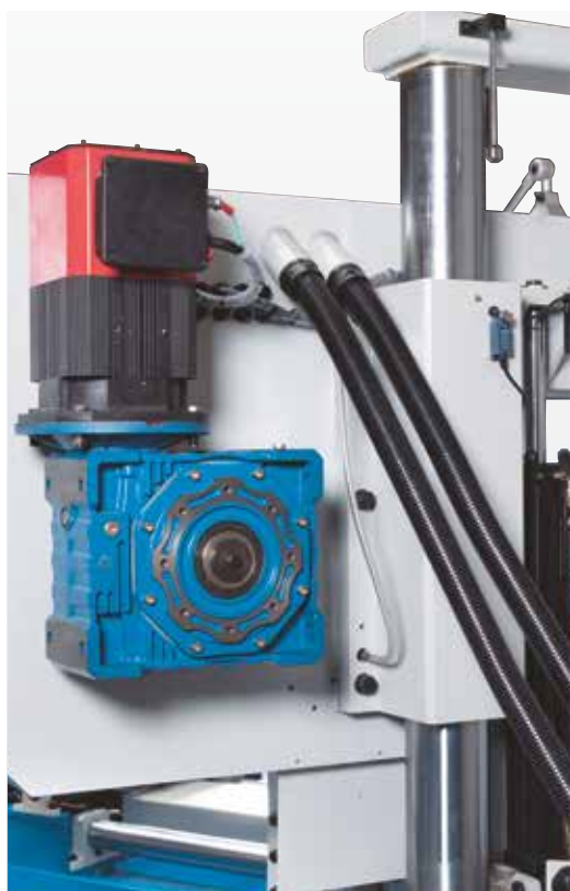
Płynnie regulowany serwomotor z dużym momentem obrotowym
