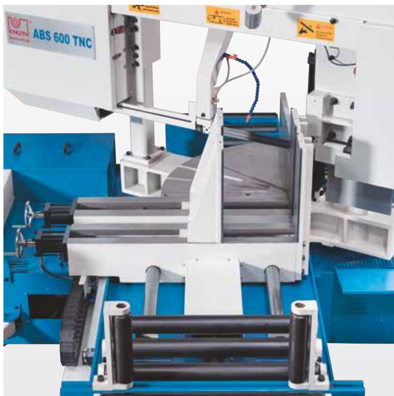
Ajuste manual del ángulo del bastidor de la sierra con accionamiento hidráulico (15°. 30° y 45°)
