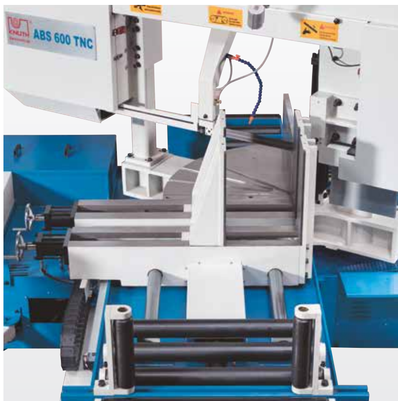
Der gewünschte Sägewinkel wird automatisch positioniert (15°, 30°, 45°)
