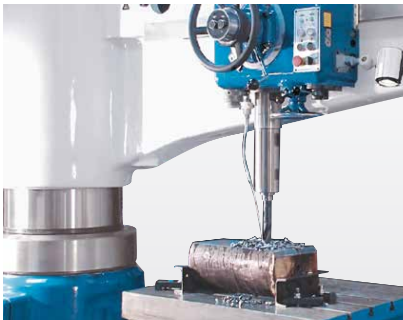
Așchiere puternică în modul automat de înaintare
