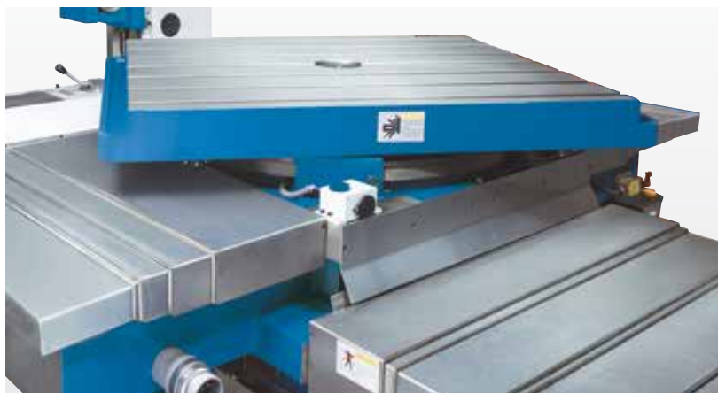
Mesa de ajuste giratorio con alimentación motorizada y sujeción hidráulica
