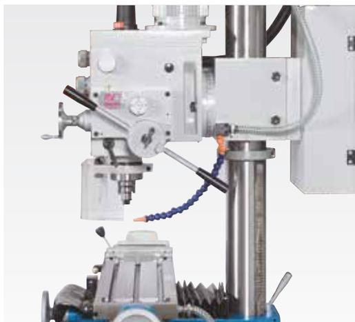
Automatischer Pinolenvorschub mit 3-Stufengetriebe
