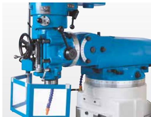
La tête de fraisage est orientable et inclinable pour le perçage angulaire
