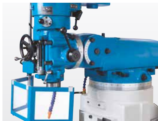
El cabezal de la fresa gira y se inclina para agujeros angulares
