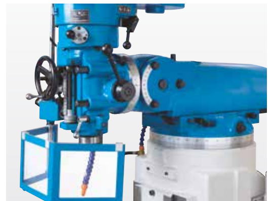
Der Fräskopf ist schwenk- und neigbar für Bohrungen im Winkel
