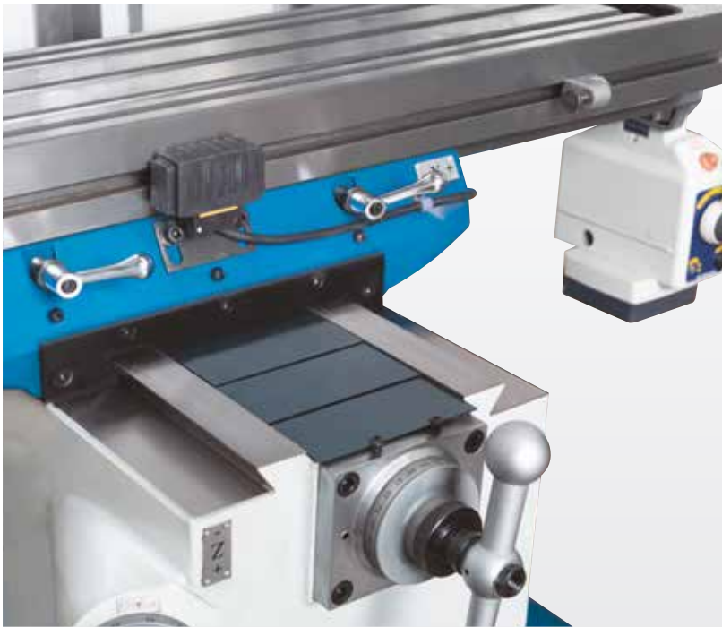
Gehärtete, präzise einstellbare Schwalbenschwanzführungen in allen Achsen
