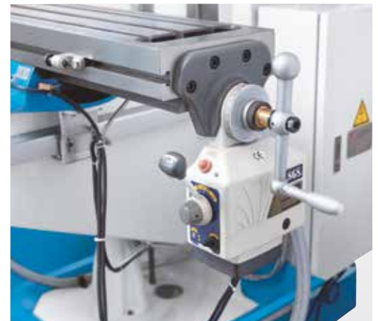
Stufenlos regelbarer Vorschub in der X-Achse
