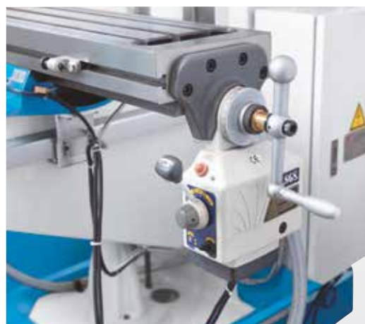
Plynule regulovatelný posuv v ose X
