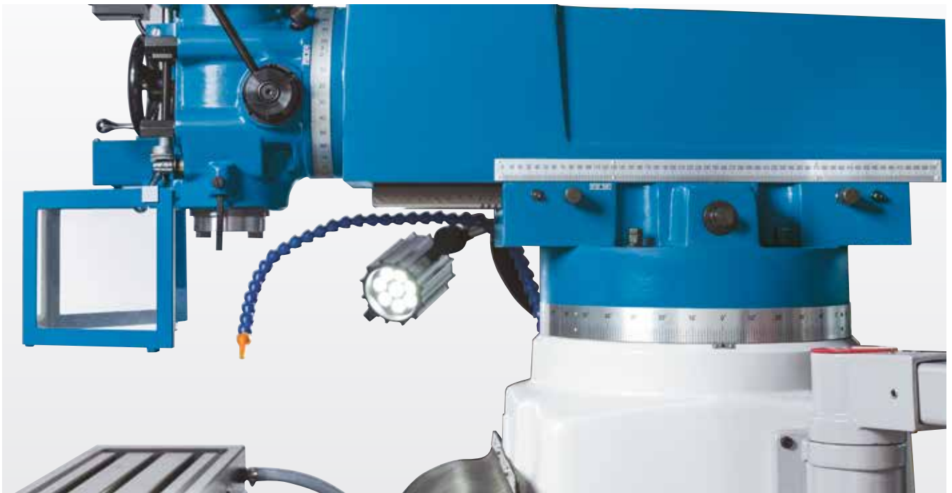
Bezstopniowa regulacja prędkości oraz ustawny kąt przechyłu głowicy
