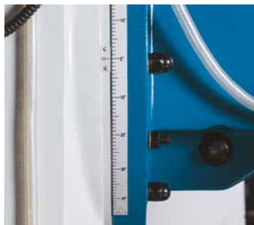
Cap de frezare rigid cu posibilitate de inclinare stanga/ dreapta
