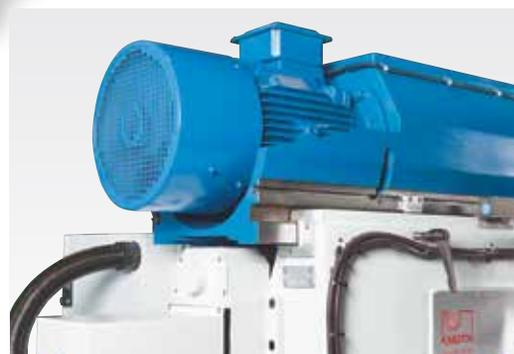
Мощный привод главного шпинделя с зубчатой коробкой передач (Servomill® UWF 12)
