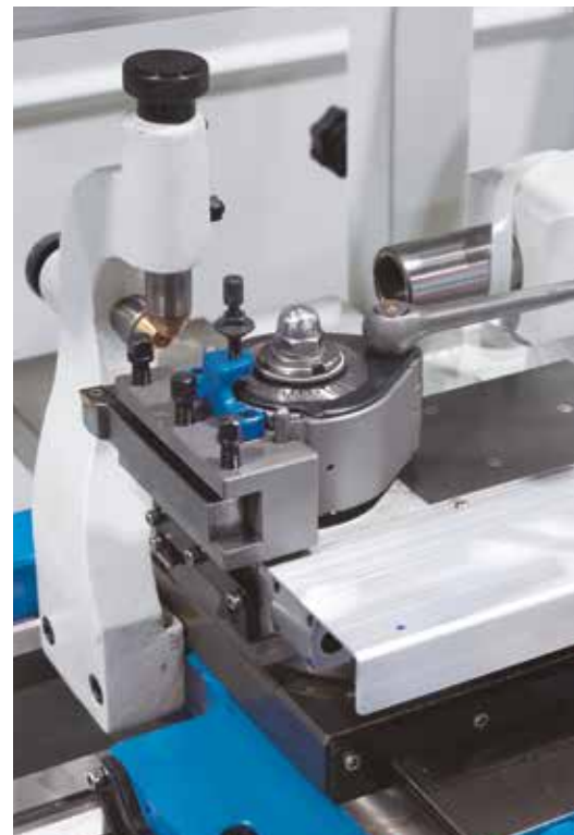
W systemie uchwytów szybkowymiennych szybko gotowe do użycia są noże tokarskie
