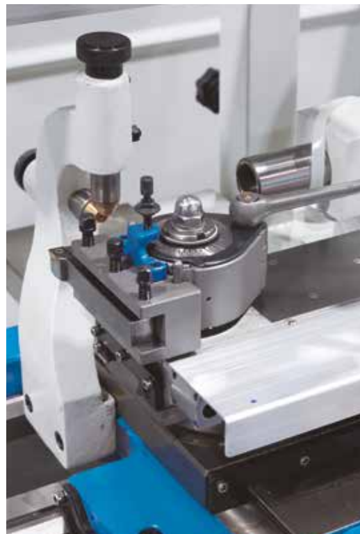
Díky rychloupínacímu držáku jsou soustružnické nože rychle připraveny k použití
