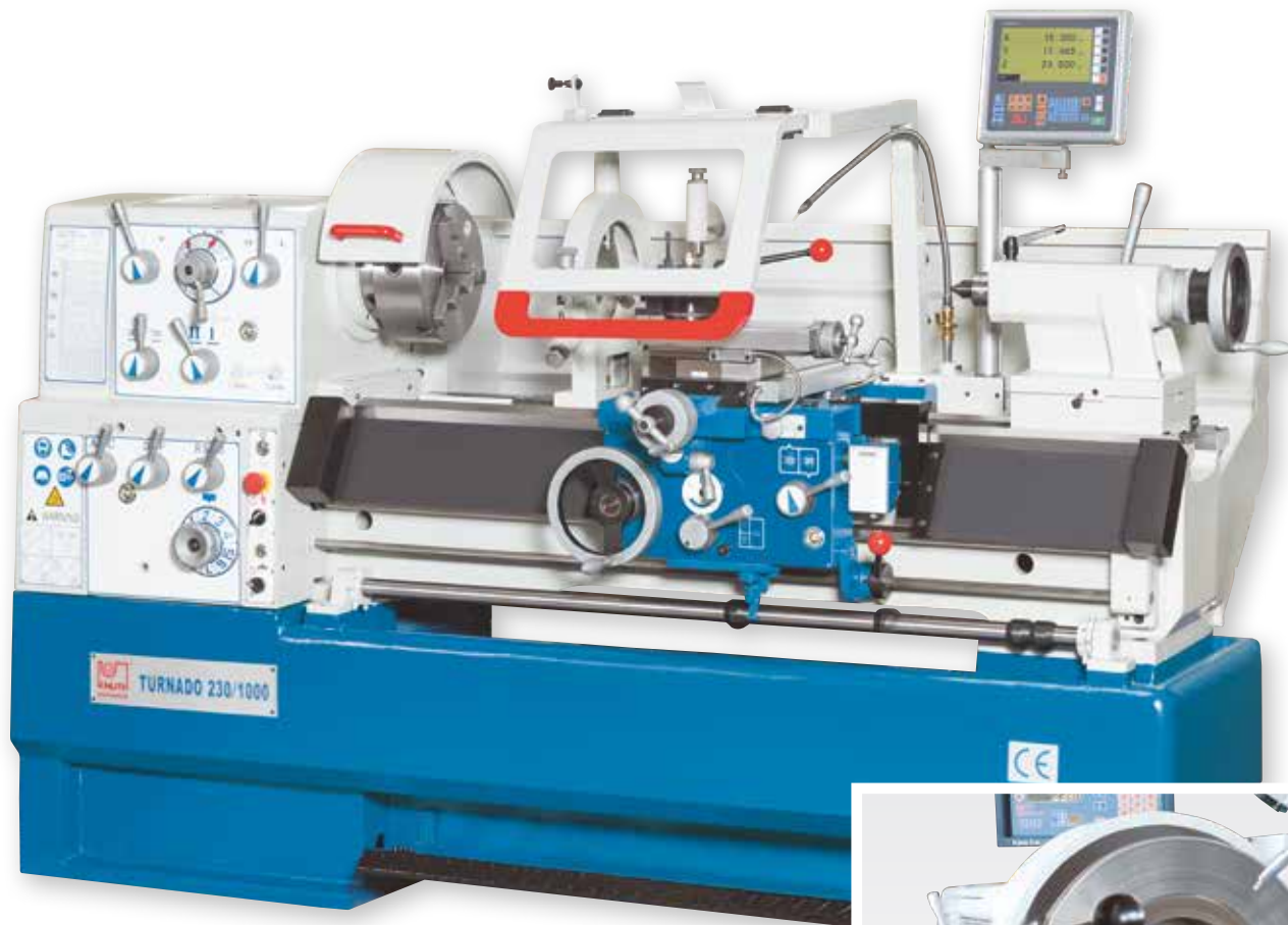
Rys. Turnado 230/ 1000 z 3-osiowym wskaźnikiem położenia
