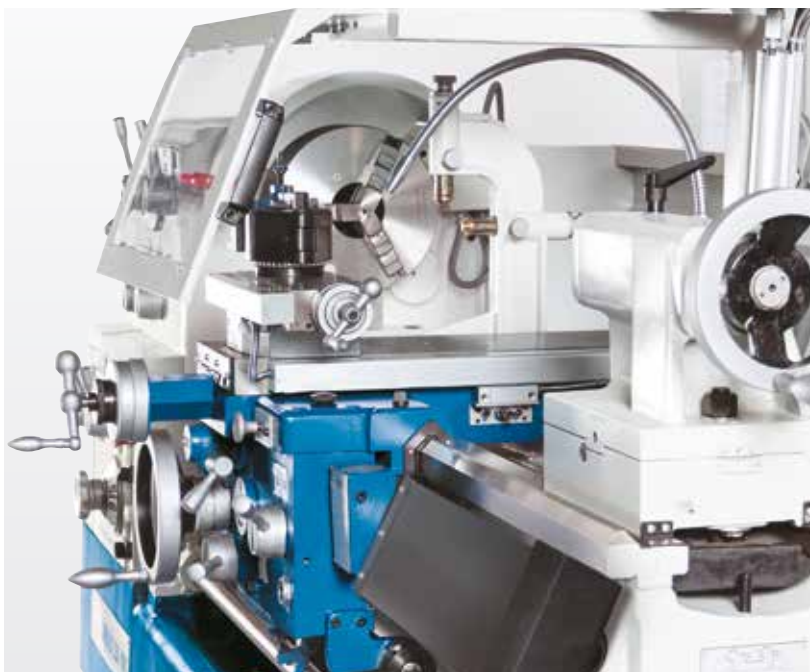
Stała i przesuwana luneta-podtrzymka seryjnie
