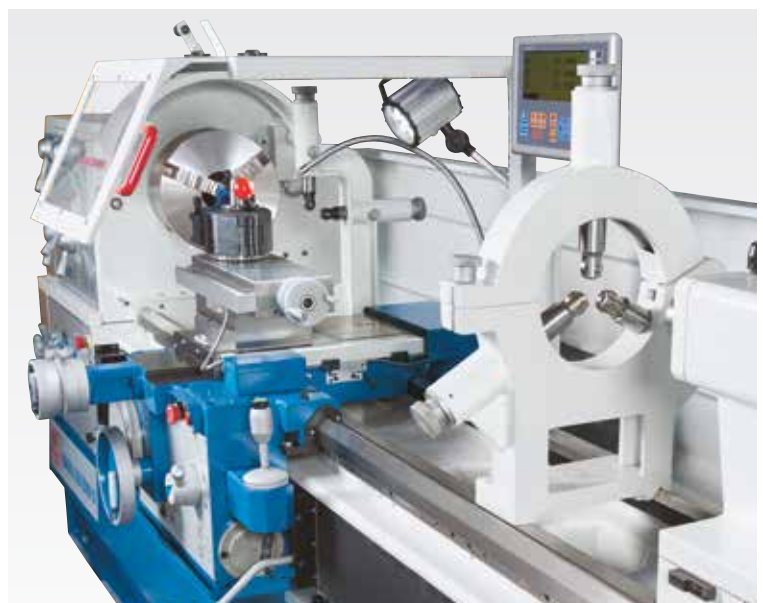
Lünetten zur präzisen Bearbeitung langer Werkstücke
