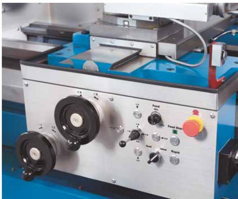
Microcontrol a través de ruedas manuales electrónicas – pero la manipulación y el posicionamiento son iguales a los de una máquina convencional
