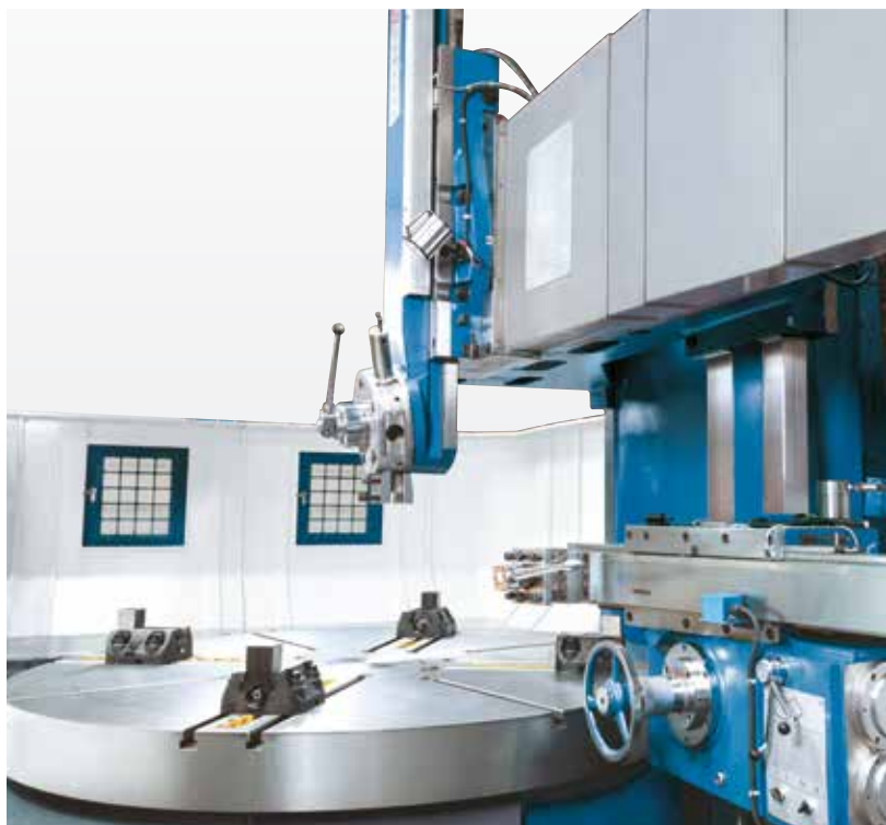
Вертикальный суппорт с 5-позиционной державкой для инструмента и боковым суппортом с собственной подачей для внутренней и внешней обработки
