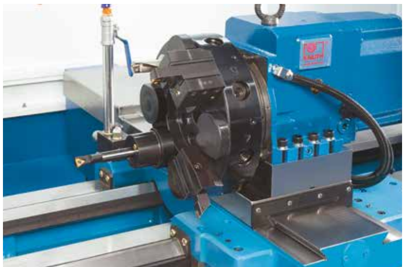
Torreta de herramientas VDI 30 con 8 estaciones
