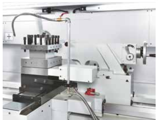
Leichte Handhabung: zum Positionieren kann der Reitstock an den Support gekoppelt werden
