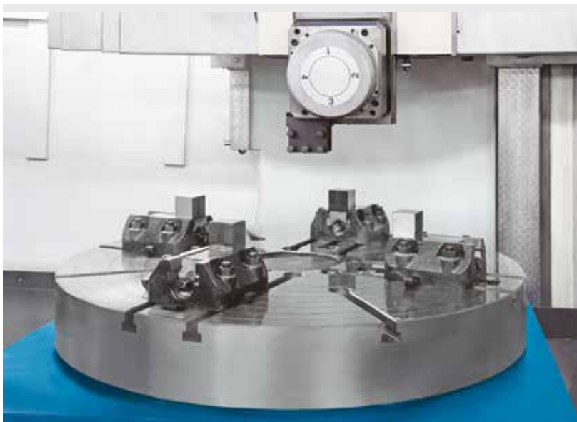
Зажимная шайба с 4-позиционным инструментальным магазином
